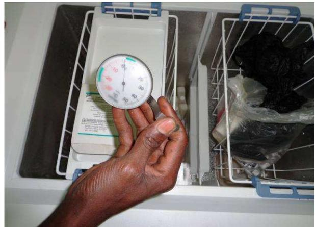
*Le réfrigérateur solaire en marche, indiquant ici une température de 0°C.*
