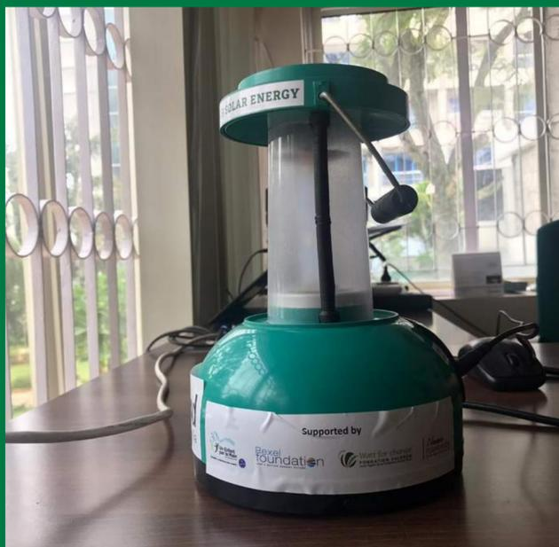
**Lampe solaire de marque Havells : module solaire photovoltaïque de 10 Wc avec 2 mètres de fil 7,2 V, avec batterie au lithium 2,2 Ah et chargeur CA.**
